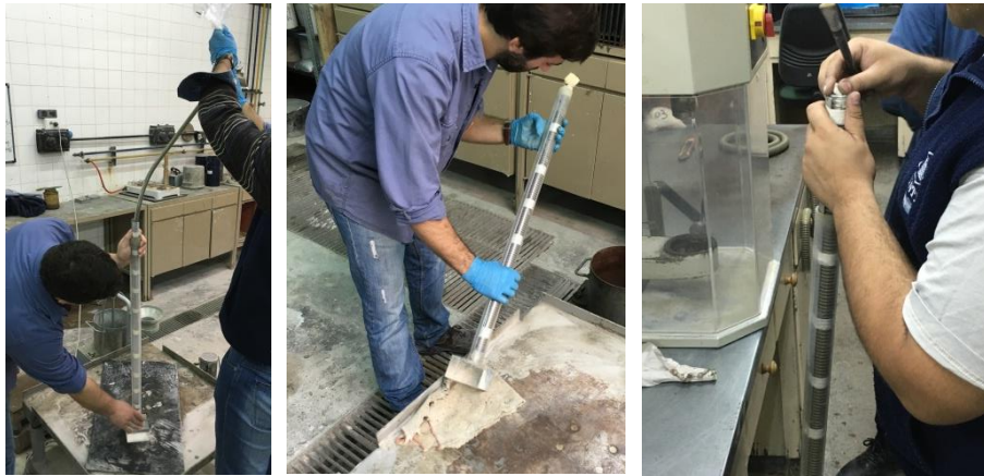
Figuras 2, 3, 4: Moldeo de probetas
